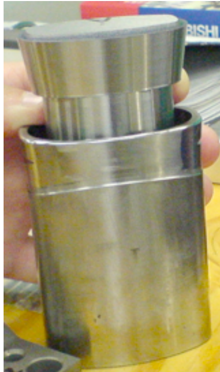
Abb. 8: Aufbau des Werkzeugs mit Stempel und Hülle
